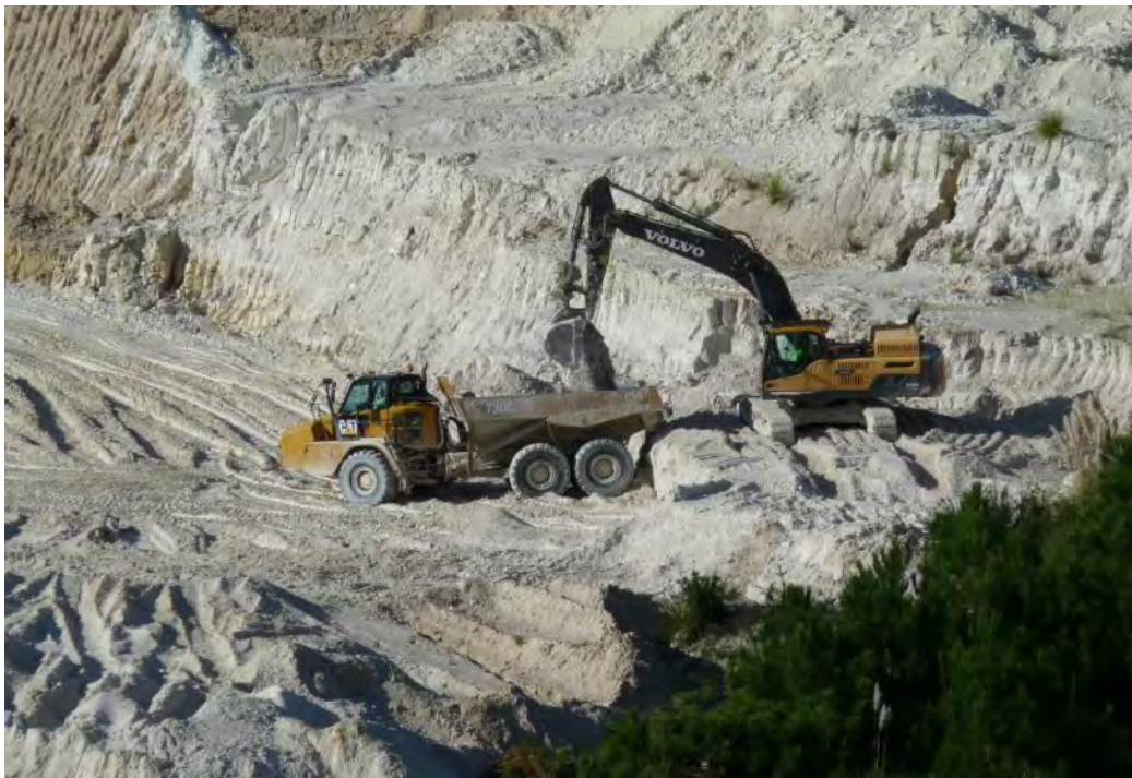
Figure 16 : Extraction du kaolin à la pelle hydraulique (ENCÉM)
