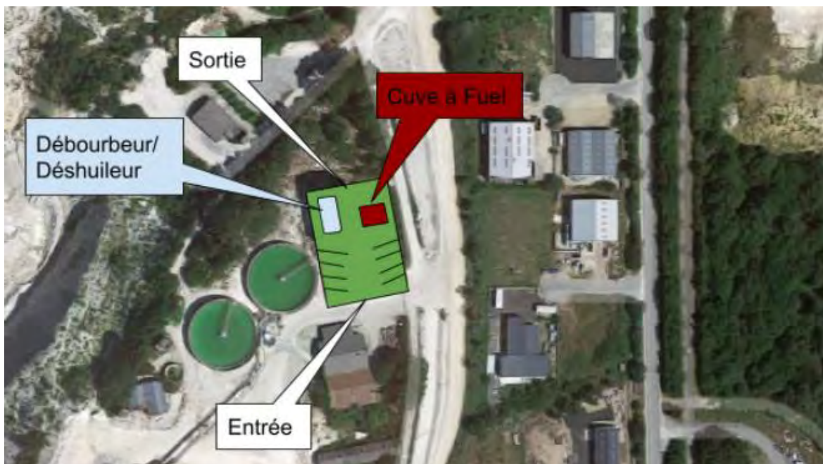
Figure 43 : Aire de Parking, lavage et de ravitaillement des engins mobiles (IMERYS CF)
